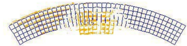
Figura 4.8: vista lateral do modo de falha da casca para carga quadrada de 0,20 m de lado.
