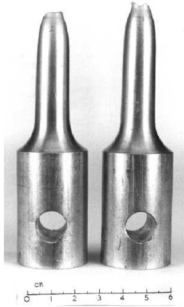
Figure 1: Estado de las probetas de aluminio después del ensayo de tracción simple
