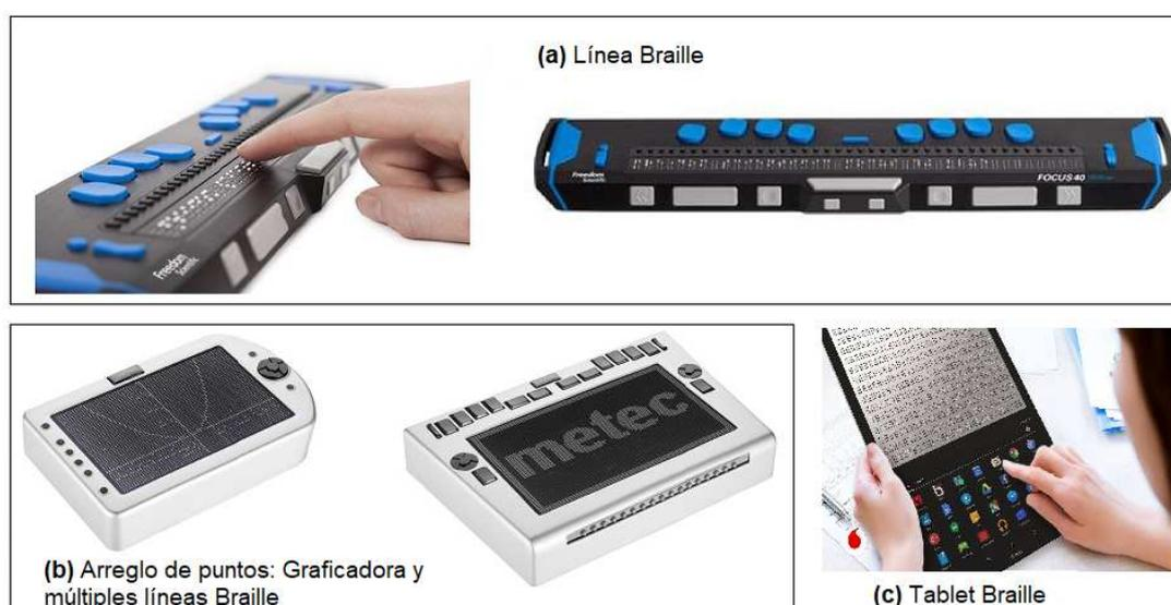
Figura 1: Dispositivos comerciales para asistencia a disminuidos visuales: (a) Línea Braille de lectura y teclado de escritura, (b) Matriz graficadora, (c) Tablet con página táctil Braille.
