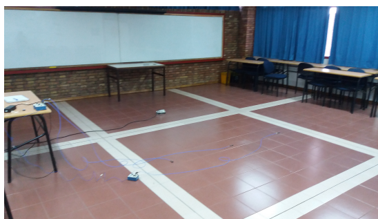
(b) Disposición de acelerómetros sobre la losa
