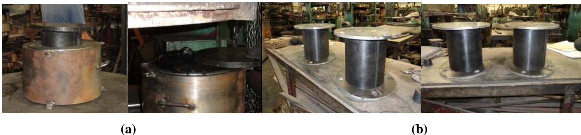
Figura 4: a) Vulcanización de los dispositivos; b) Desmolde de los dispositivos.
