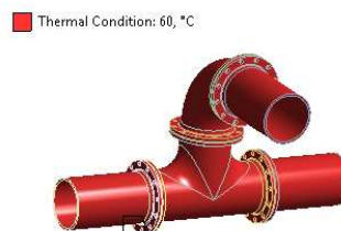
Figura 16. Carga térmica de 60°C sobre toda la estructura.
