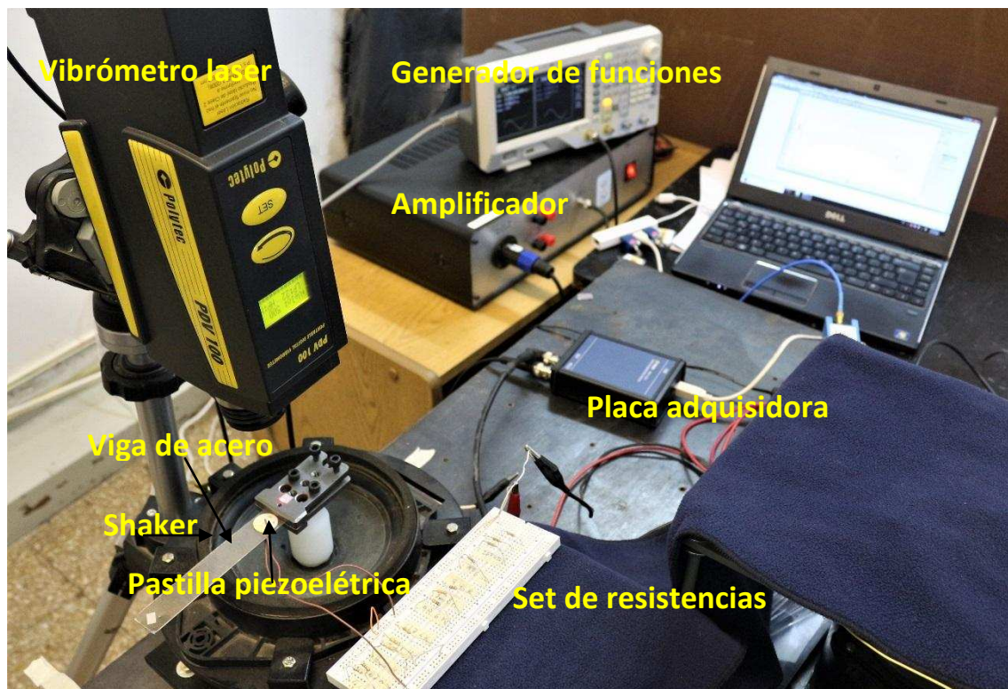
Figura 2: Diagrama esquemático del sistema estudiado
