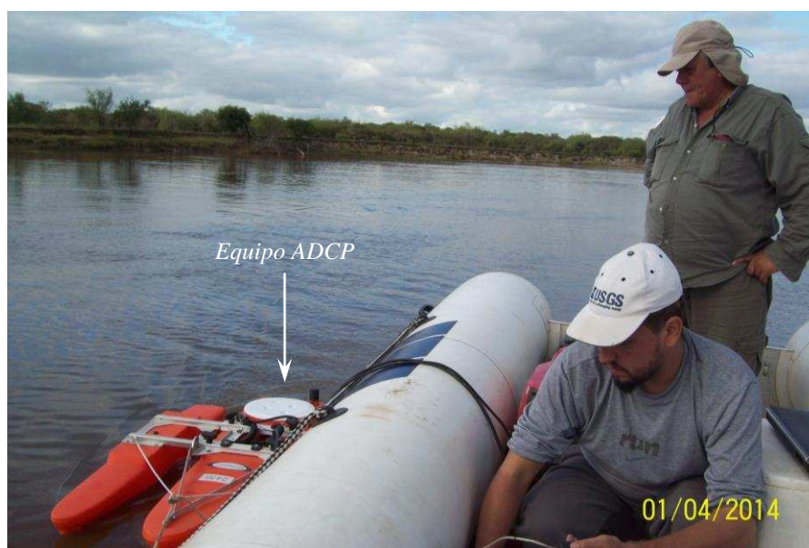
Figura 2: Equipo ADCP montado en la embarcación de trabajo.
