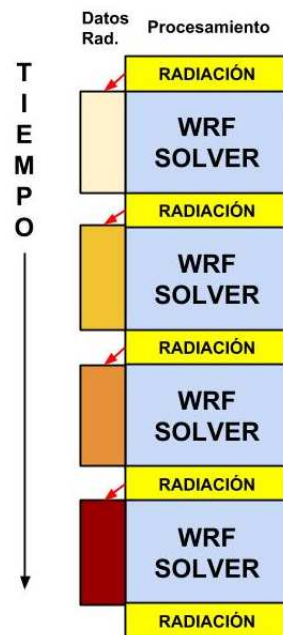
Figura 2: Funcionamiento de la arquitectura sincrónica del modelo WRF, cuando se lo divide según la porción de código que ejecuta la radiación y el resto de los módulos.
