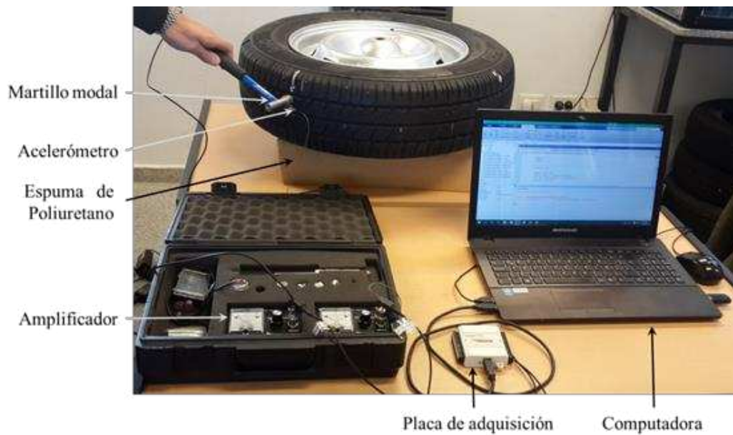
Figura 7: Disposición de elementos para el ensayo.
