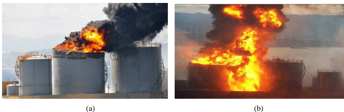
Figura 4: Fuego en tanques, (a) Desde la parte superior del tanque, (b) Desde la base del tanque
