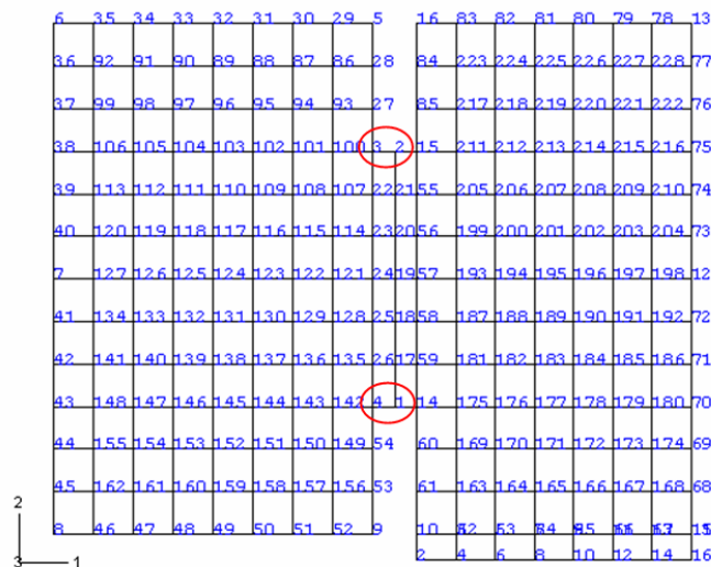
Figura 3: Malla de Elementos Finitos
