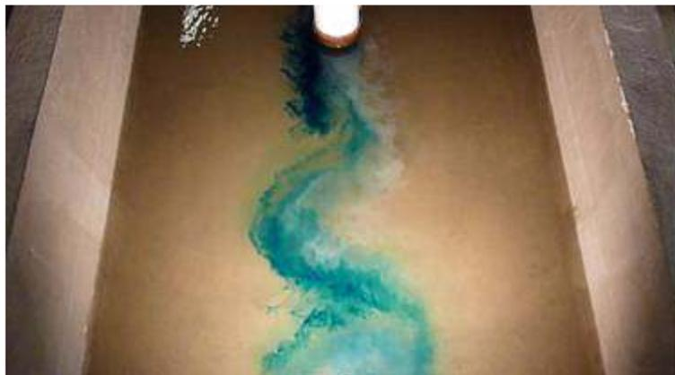
Figure 6.- Visualización del flujo en la interfase de mezcla aguas abajo de la confluencia de flujos paralelos.
