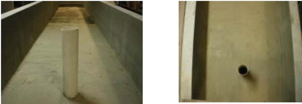
Figura 1.- Vista frontal (izq.) y en planta (der.) de la configuración I): flujo en presencia de un obstáculo.
