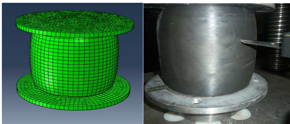
Figura 4: Modelo del aislador elastomérico baja carga axial de compresión y respuesta de los ensayos experimentales
