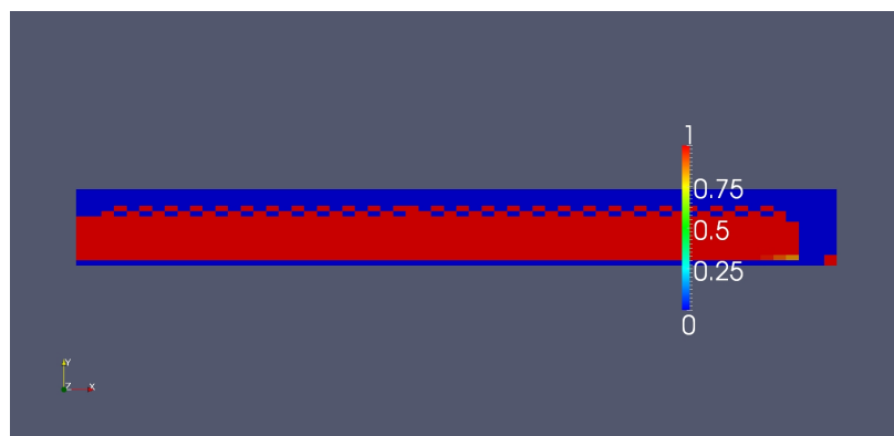
Figura 6: Distribución óptima del espesor relativo de las capas horizontales ( h_I/l ) de la microestructura para maximizar la rigidez de la viga.
