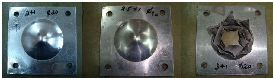
Figura 7: Deformación y rotura de placas 4Al
