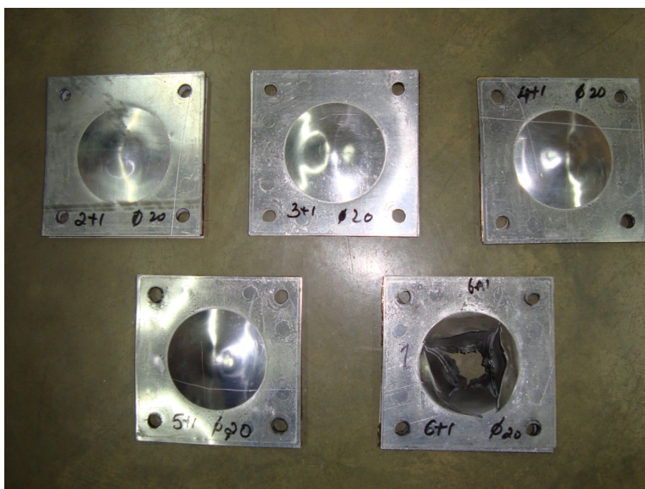
Figura 8: Deformación y rotura de placas 6Al
