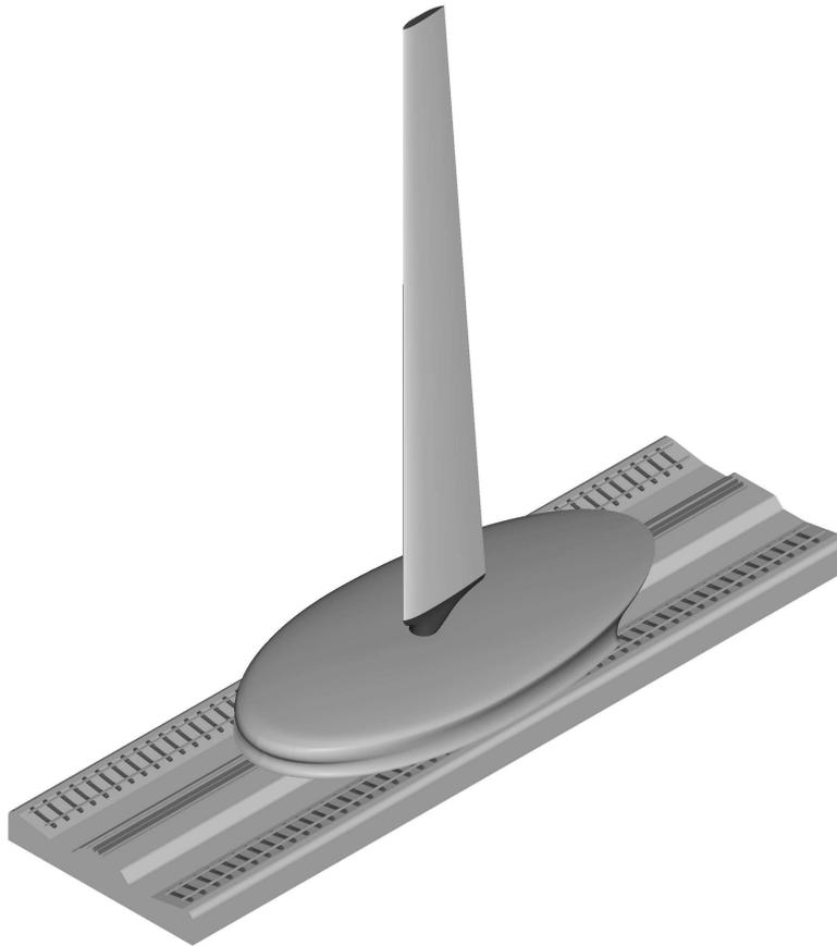
Figura 1: Elemento generador del Rotor VGOT Darrieus.
