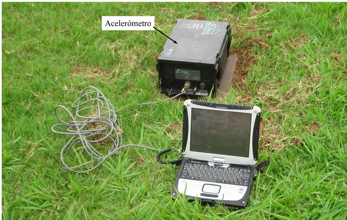
Figura 9: Acelerómetro Etna y ordenador.
