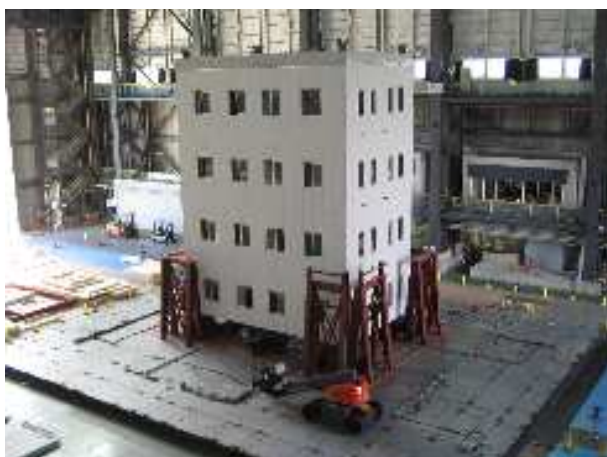
Figura 3: Pórtico metálico ensayado en el Laboratorio E-Defense de Japón.
