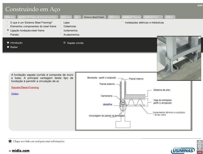
Figura 12: Ligação sapata corrida steel frame
