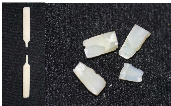
Figura 10: Corpos de provas rompidos nos ensaios de tração, compressão (Franco, 2008).
