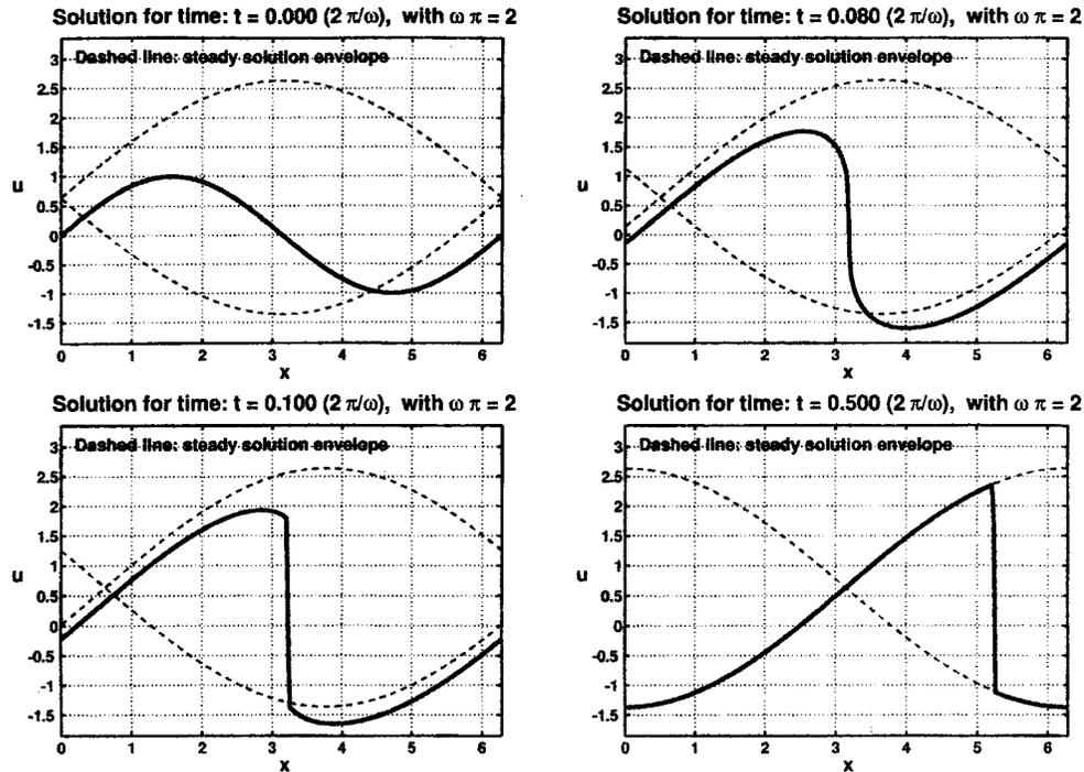
Figura 2: Término forzante  $f = \sin z$  con  $z = x - \omega t$  y  $\omega = \omega_{cr}/2 = 2/\pi$ . Cuando  $t \rightarrow \infty$  la solución converge a la onda viajera  $u = \omega \pm 2 \sin(z/2)$ , donde el cambio de signo ocurre en la posición del choque. La onda viajera tiene período  $2\pi/\omega$  en el tiempo.
