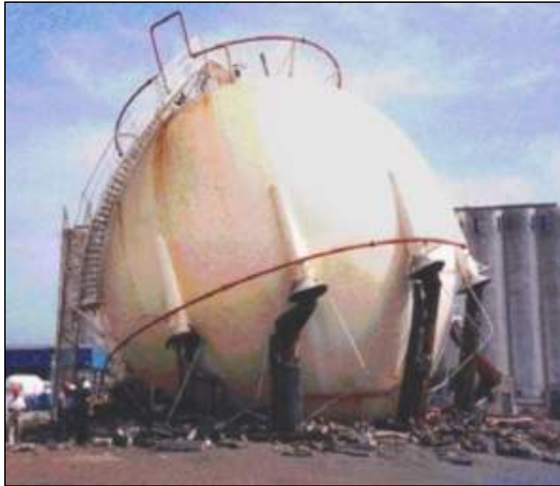
Figura 2 – Falla de contenedor esférico de LPG
