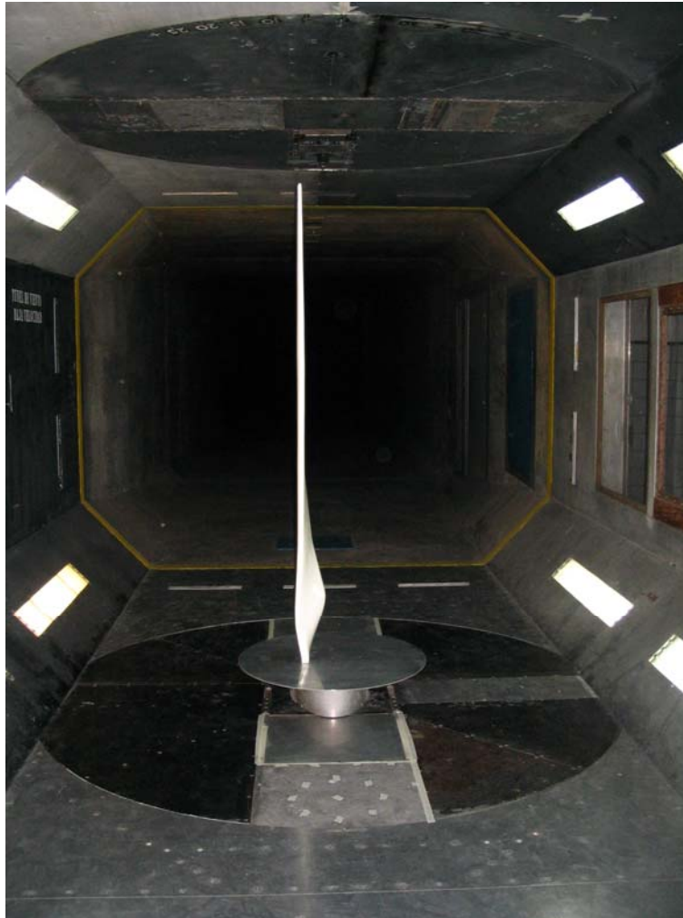
Figura 6 Montaje Completo (Modelo instalado, placa separadora y carenado balanza)
