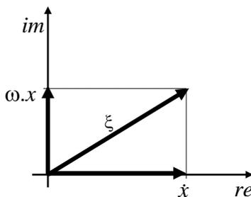
Como se ve en la figura, la (147) representa las coordenadas de  $\xi$  en el plano de fases, con el eje imaginario deformado por  $\omega$ .
