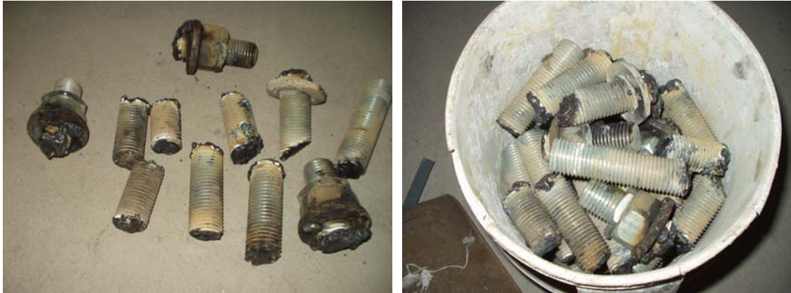
Fig. 9.27: Eliminación de los bulones de precompresión del aislador de resortes helicoidales metálicos para liberar su movimiento.
