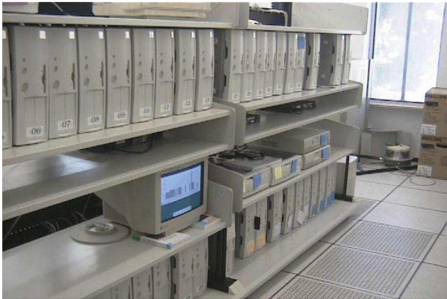
Figura 2: Cluster del Institute of Computer Science, Hebrew University, Israel. Cuenta con 55 nodos (cuadruple, doble, simple) P-III 1GHz - 550 MHz, 128-256MB RAM, conectado por Ether-Express Pro 100 NICs. ([www.mosix.org](http://www.mosix.org)). Un cluster de este tipo puede tener un desempeño del orden de unos 50 GFLOPS por un precio de unos 50.000 U\$S.
