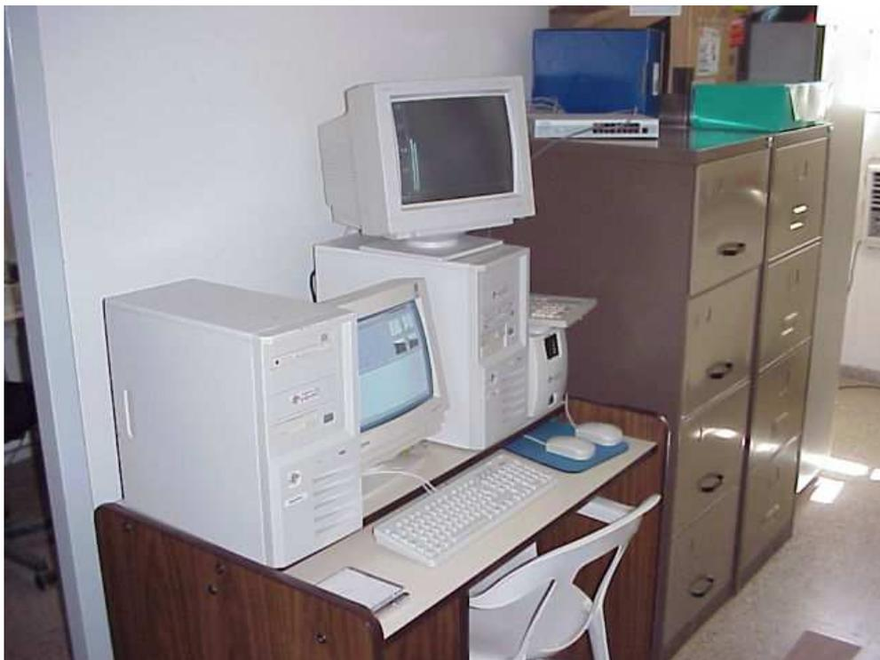
Figura 6: Aspecto del cluster prototipo basado en dos PCs Pentium III conectadas a través de un switch, con sistema operativo Linux y núcleo MOSIX.
